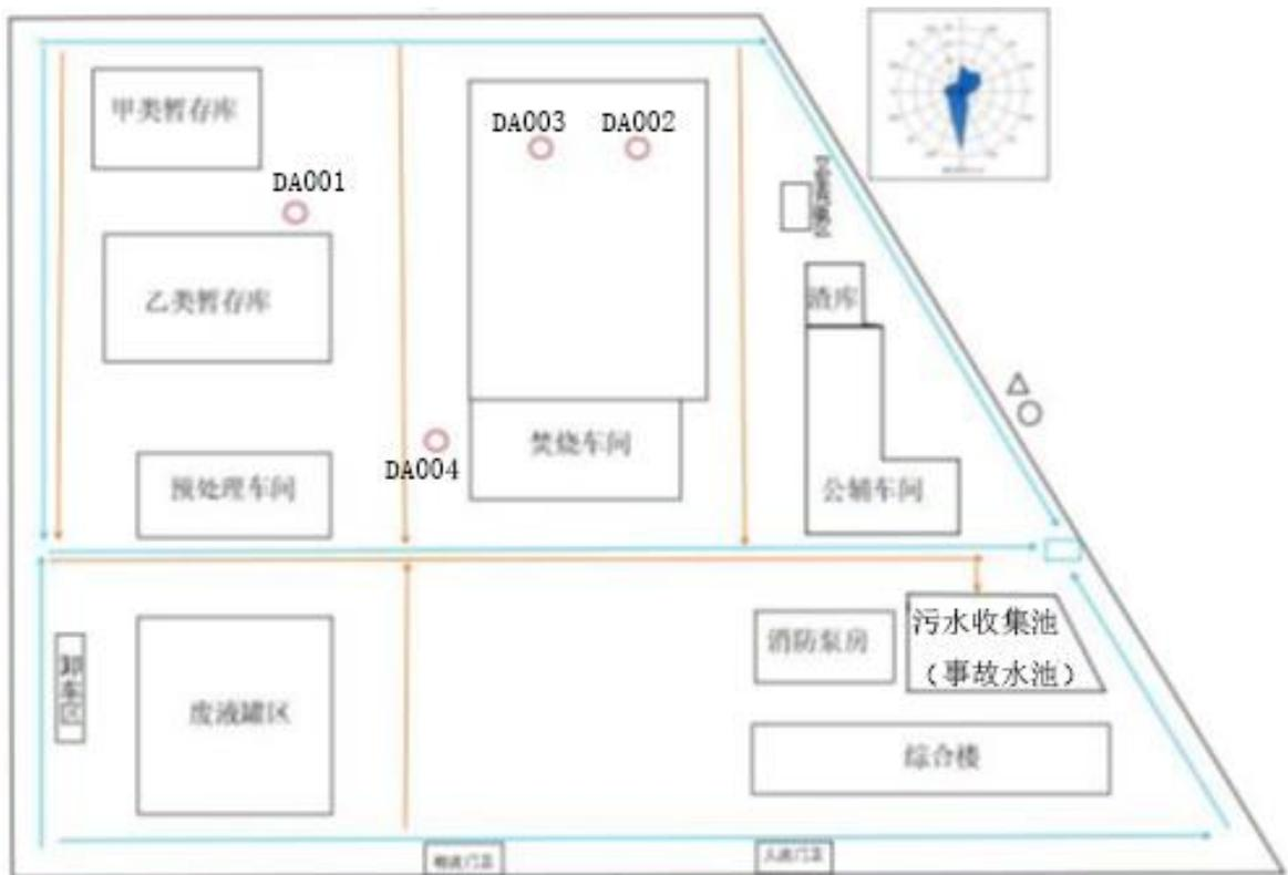
图 4.2-1 污水雨水排放走向图
